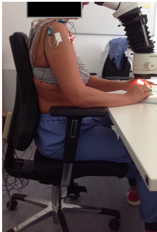
Abb. 8: Versuchsaufbau und Anbringung der Messelektroden
