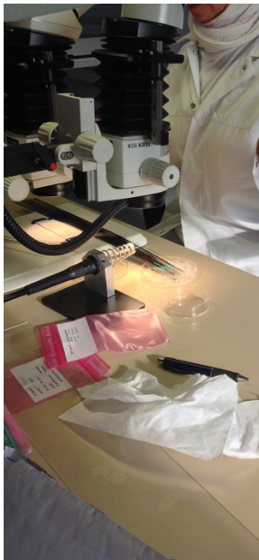
Abb. 4 und 5; Versuchsaufbau mit Mikroskop, Petrischale mit Röntgenmarkern, Pinzette, Katheterdrähten
