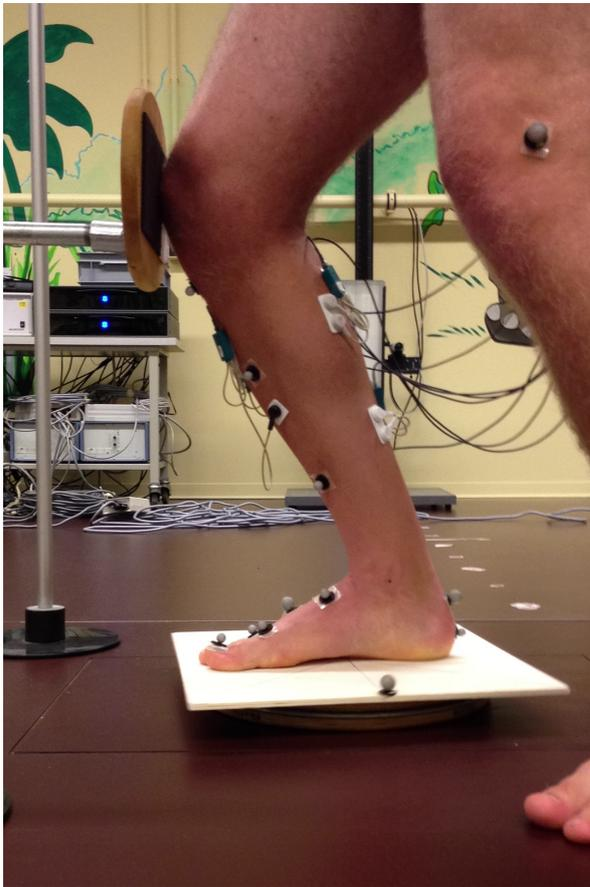
*Abb. 23: Messanordnung mit Kniekontakt und Disc auf der Kraftmessplatte (Hentschel)*
