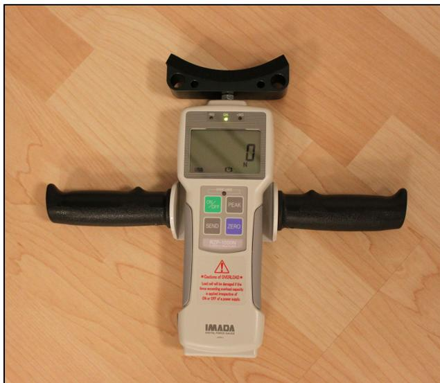
**Abbildung 5:** Das handgehaltene Kraftmessgerät IMADA RZP-1000
